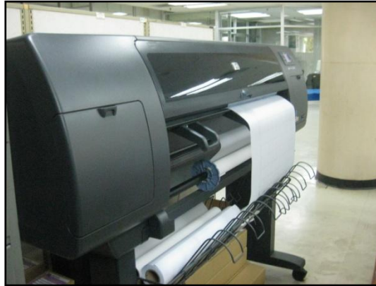
ภาพที่ ๑๓ การพล็อตแผ่นทาบระวาง แสดงผลการอ่านแปลฯ ด้วยเครื่องพล็อตเตอร์
