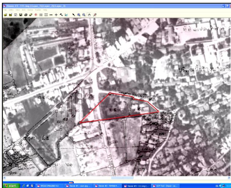
ภาพที่ ๒ ข้อมูลรูปแปลงที่ดินที่สำนักงานที่ดินได้หมายขอบเขตลงบนระวางแผนที่ภาพถ่ายทางอากาศ
