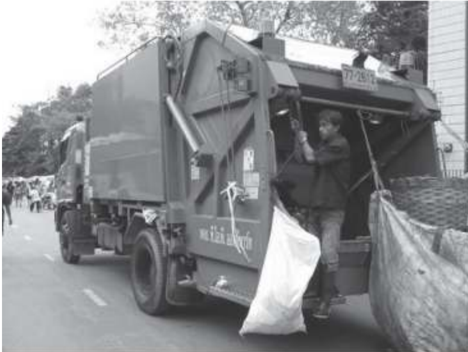
รูปรถขนขยะที่เสริมอุปกรณ์แยกขยะแบบไทยๆ
